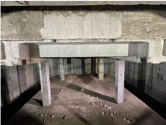
破壊実験用に再現されたモスクワの地下鉄駅
